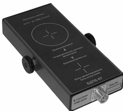
1.4.4. Внешний вид выносного блока детектирования БДПБ-07.
