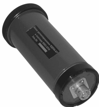
1.4.3. Внешний вид выносного блока детектирования БДПА-07.
