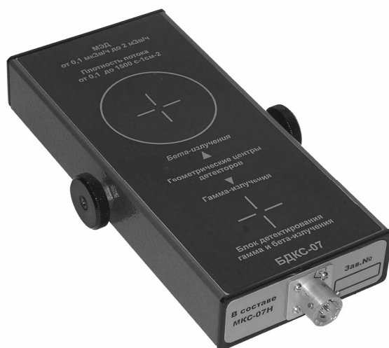
1.4.5. Внешний вид выносного блока детектирования БДКС-07.
